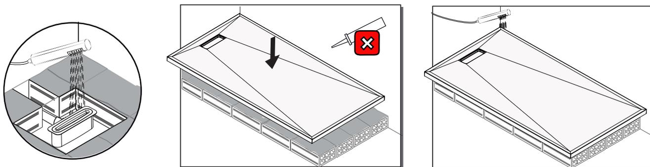
3. Appliquer du mastic PU/MS ou du silicone entre le receveur et la base afin de le fixer. Appliquer un filet de silicone sur les joints du receveur de douche avec le mur et le sol.
