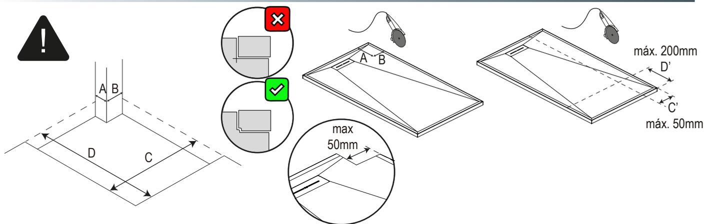
1. Créer une surface d'appui homogène sur toute la dimension à l'aide d'un mortier d'égalisation et respecter le temps de séchage indiqué par le fabricant.
