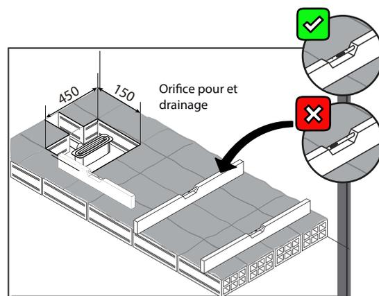
Ne pas aligner la chute d'eau et le siphon afin de ne pas altérer la capacité d'évacuation de l'eau.
