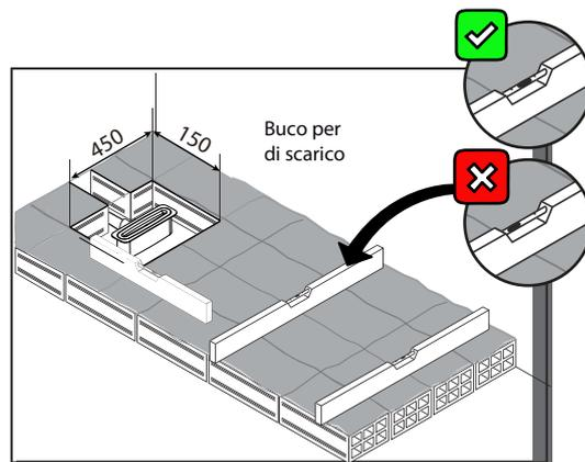
Controllare che il foro di scarico e il sifone non si trovino sullo stesso piano, per non compromettere la capacità di scarico.
