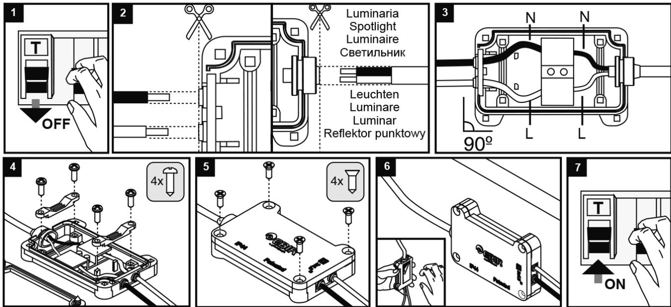
1. Débranchez l'interrupteur principal de l'installation électrique.
